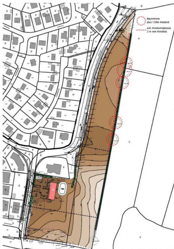
Abbildung 2: Geländehöhen im Bestand
